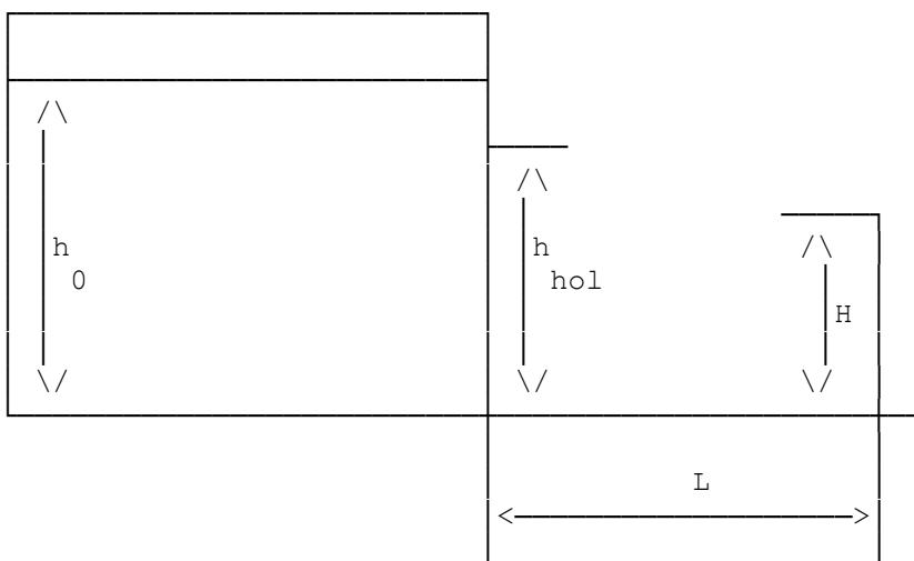
Рис. П3.1. Схема для расчета истечения жидкости из отверстия в резервуаре
