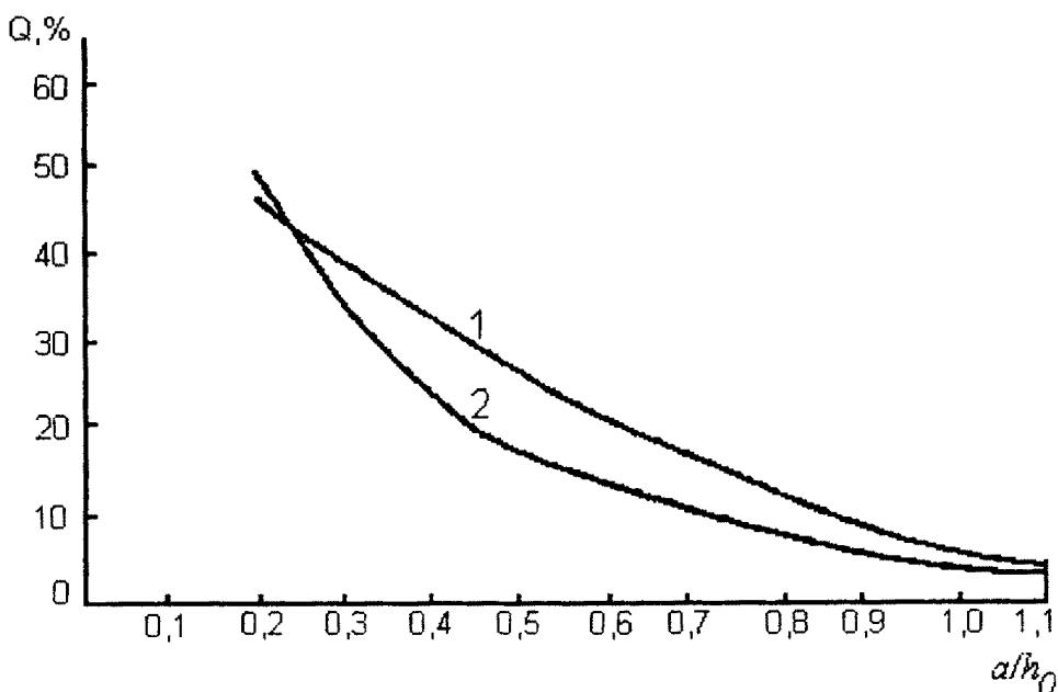
Рис. П3.3. Зависимость доли перелившейся через обвалование жидкости  $Q$  от параметра  $a/h_0$ : 1 - расчет; 2 - эксперимент
