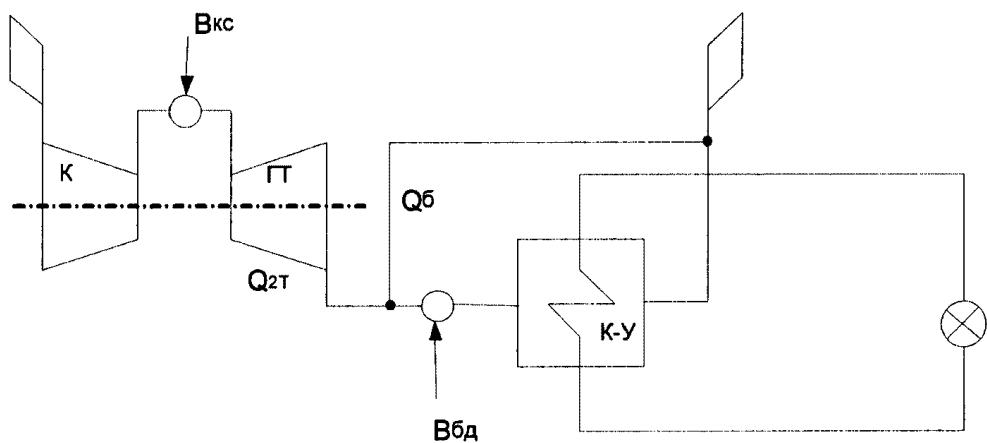
Рисунок 1. Схема ГТУ с утилизацией тепла
