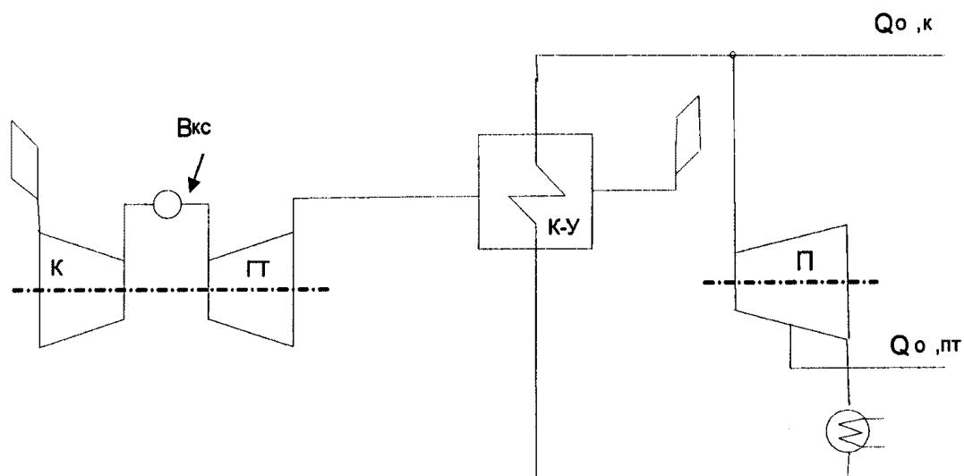
Рисунок 2. Схема ПГУ утилизационного типа
