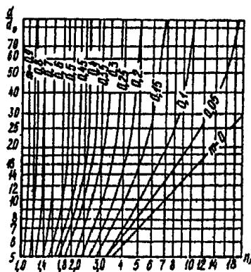
Рис. 2. Номограмма для определения начального разбавления в потоке
