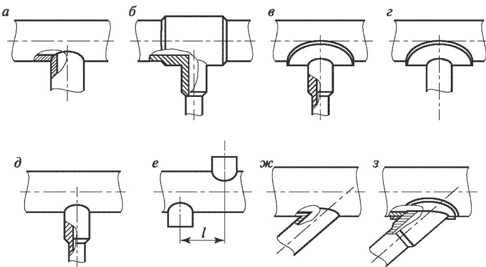
Рис. 1. Ответвления на технологических трубопроводах:
