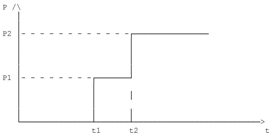
Рис. 1. Р - давление пуска; Р2 - давление рабочее;
