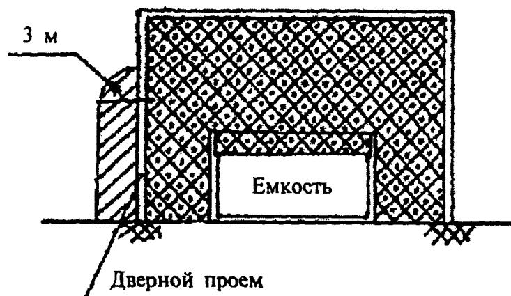
Рис. 1. Открытые емкости, аппараты, устройства в помещении
