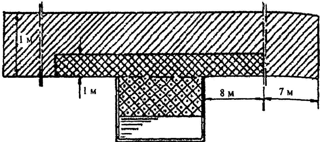
Рис. 7. Открытые пространства вокруг открытого сепаратора
