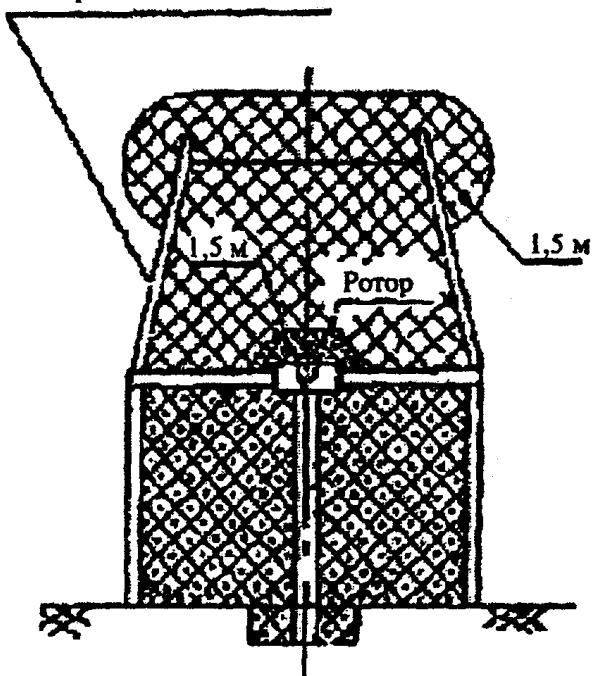
Буровая установка с огражденным подроторным пространством
