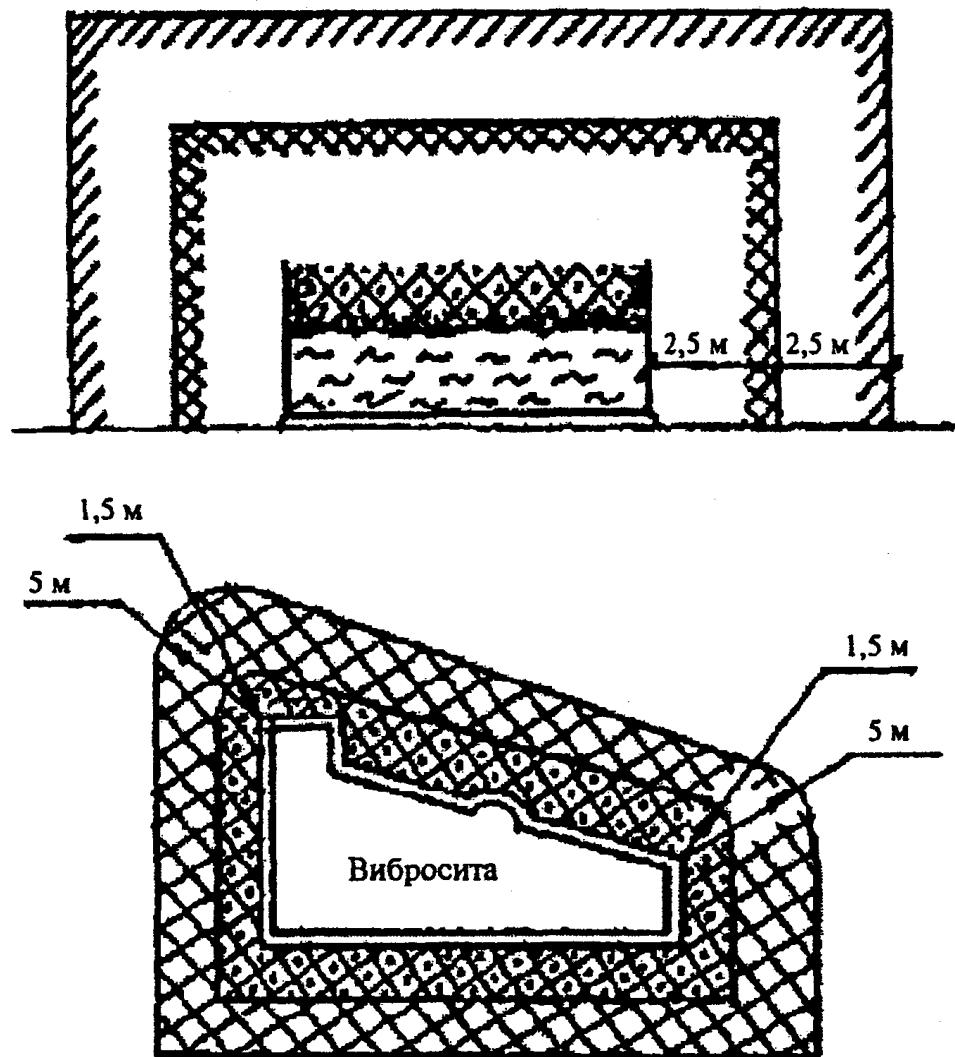
Рис. 4. Открытые пространства вокруг открытых емкостей, аппаратов, устройств
