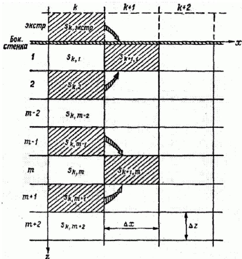
Рис. 7. Сетка к расчету турбулентной диффузии.
