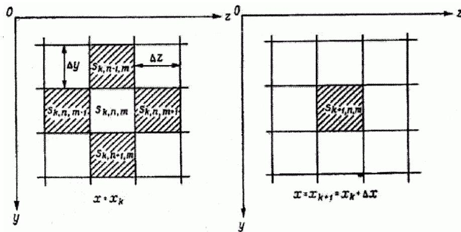
Рис. 6. Сетка к расчету турбулентной диффузии. Пространственная задача.
