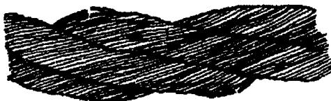
Рисунок 1. Обрывы и смещения проволок каната крестовой свивки
