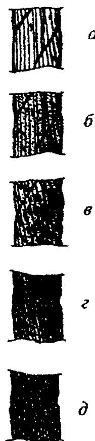
Рисунок 6. Поверхностная коррозия проволок каната крестовой свивки:
