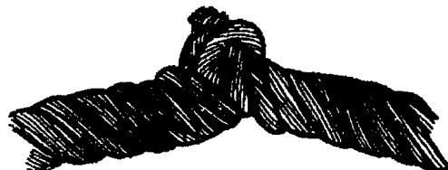
Рисунок 15. Перекручивание каната
