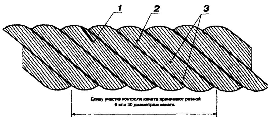
Рисунок 4. Пример определения числа обрывов наружных проволок стального каната:
