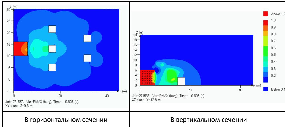
Рисунок 3-4. Распределение давления при взрыве облака ТВС
