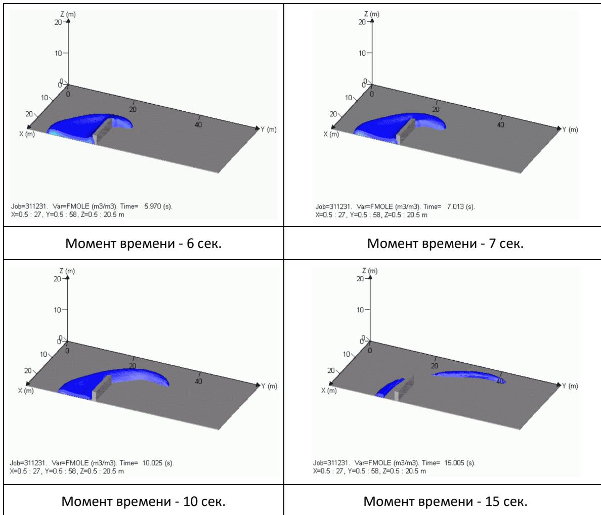
Рисунок 3-1. Профили распространения облака пропана по направлению ветра в различные моменты времени (горизонтальная поверхность с препятствием)
