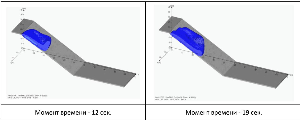
Рисунок 3-3. Профили распространения облака пропана по направлению ветра в различные моменты времени (спуск вниз)
