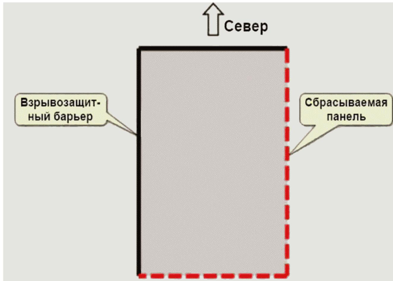
Рисунок 3-7. Конфигурация стен модуля (вид сверху)
