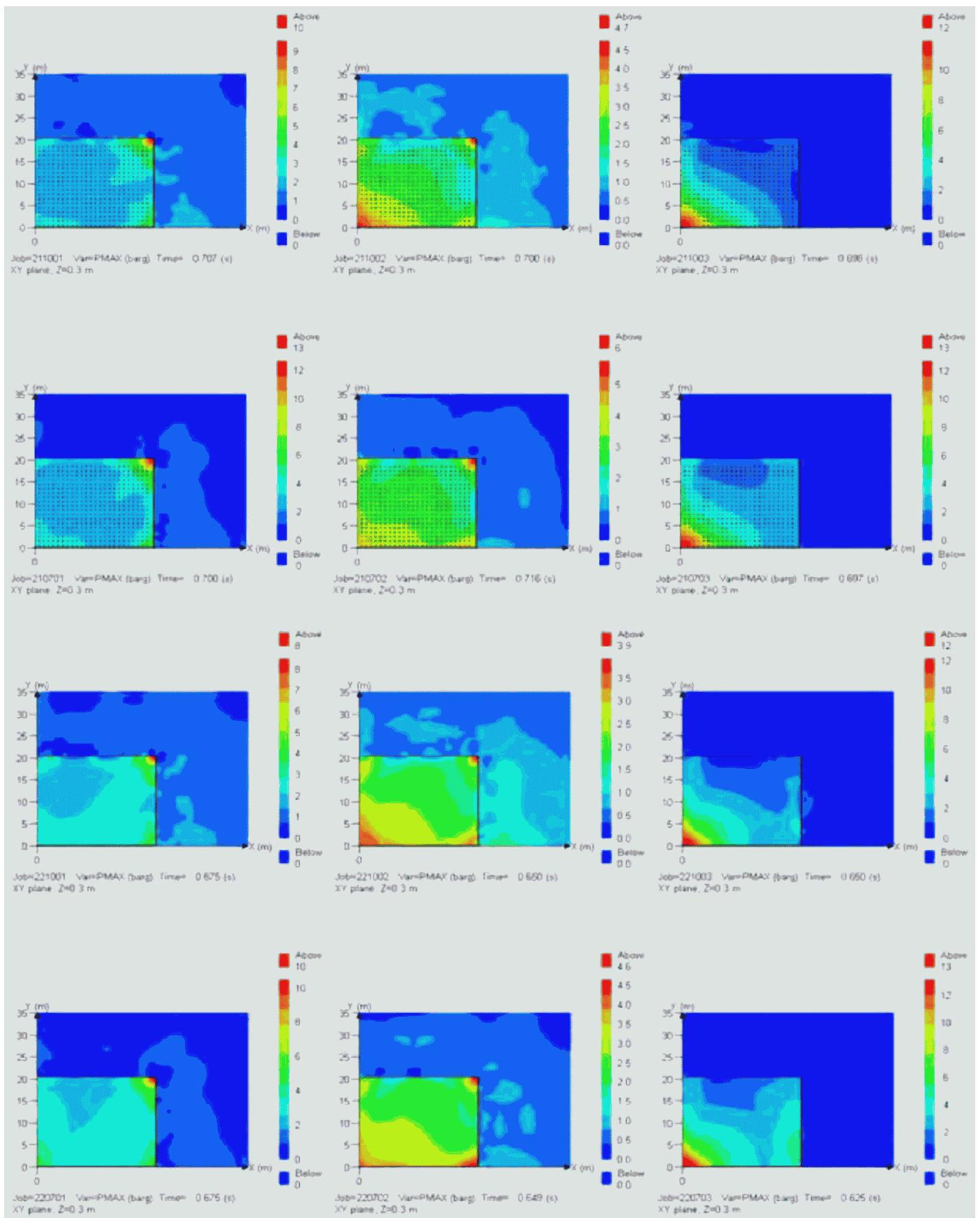
Рисунок 3-9. Распределение давления при взрыве облака ТВС при различных сценариях моделирования
