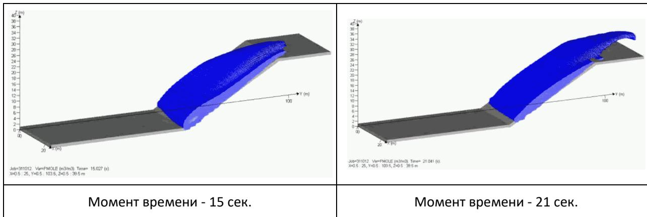
Рисунок 3-2. Профили распространения облака пропана
