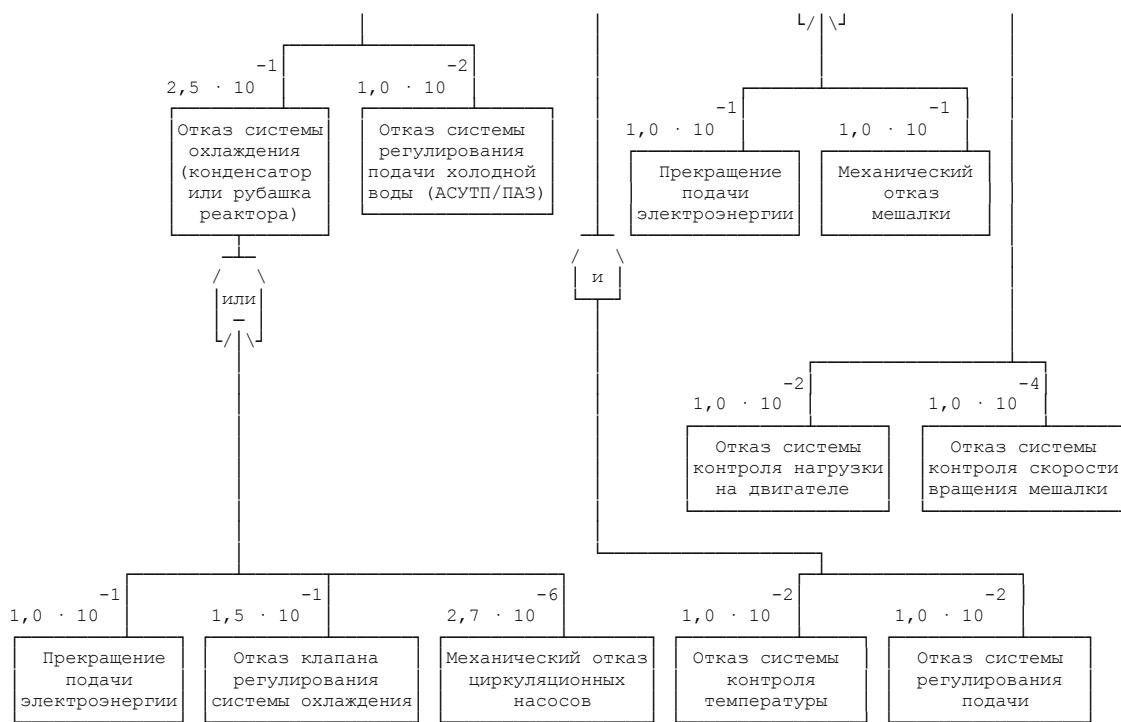
Рис. 8-1. Пример дерева отказов для химических реакторов
