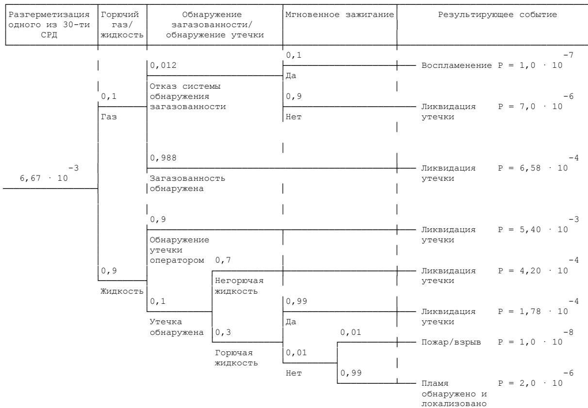
Рис. 8-2. Пример дерева событий для случая разгерметизации сосудов, работающих под давлением
