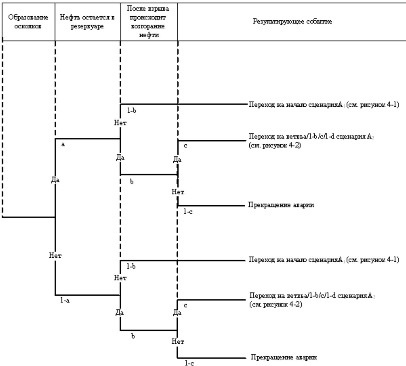
Рис. 3 "Дерево событий" при взрыве внутри наземного резервуара (сценарий А<sub>3</sub>)
