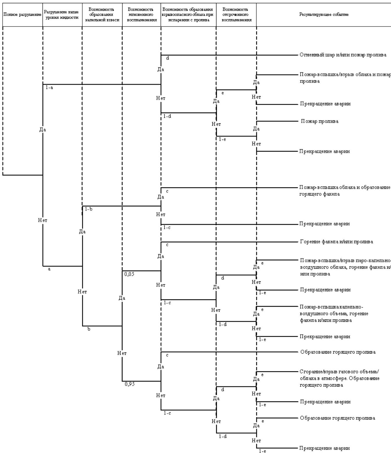
Рис. 7 "Дерево событий" при разрушении емкости под давлением (сценарий A<sub>7</sub>)
