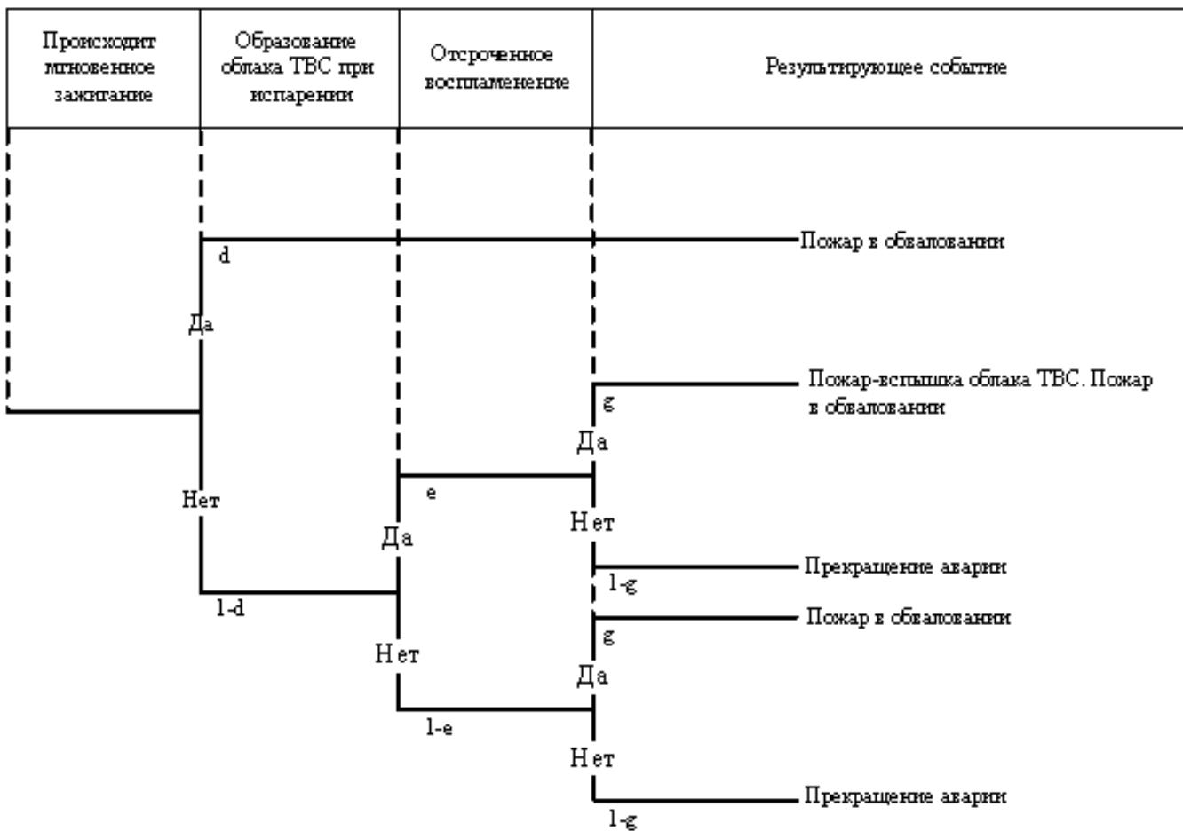
Рис. 4 "Дерево событий" разрушения/перелива подземного резервуара (сценарий А<sub>4</sub>)
