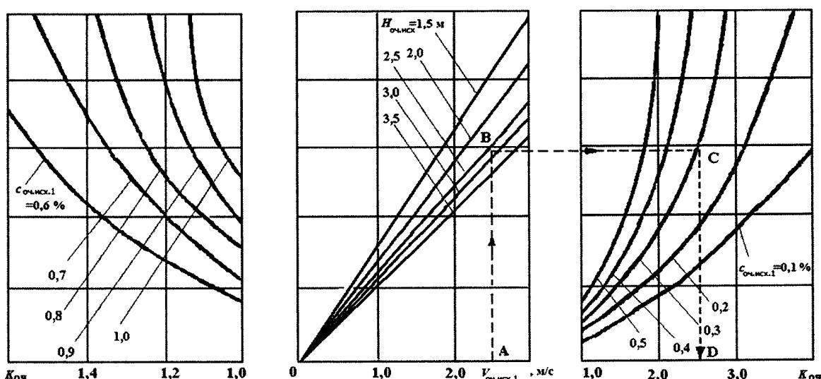
Рис. 7. Номограмма для определения  $K_{\text{оч}}$
