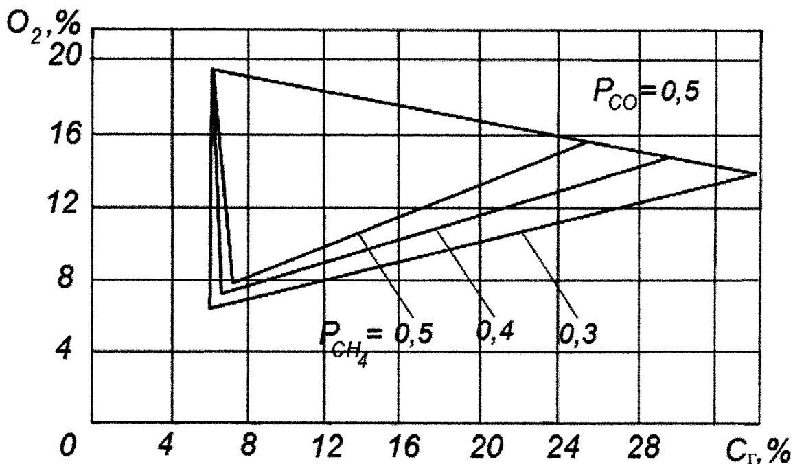
Рис. 6. Треугольник взрываемости при  $P_{CO} = 0,5$
