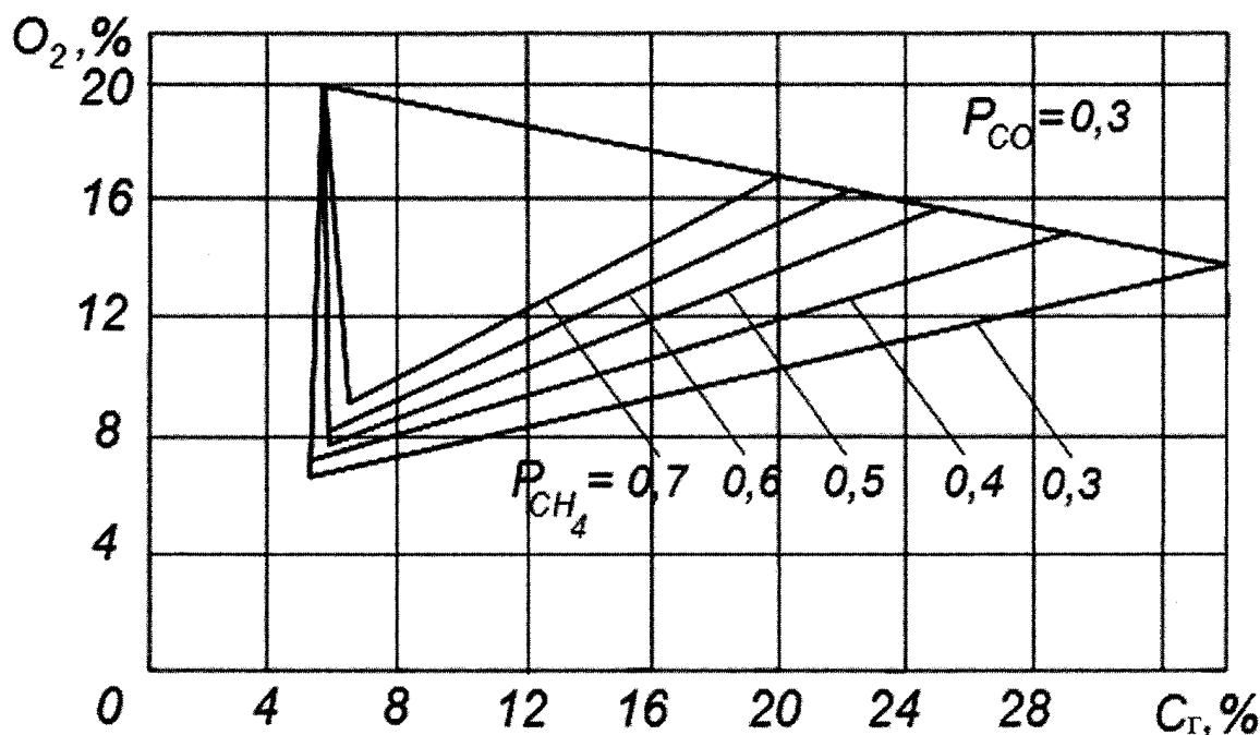
Рис. 4. Треугольник взрываемости при  $P_{CO} = 0,3$
