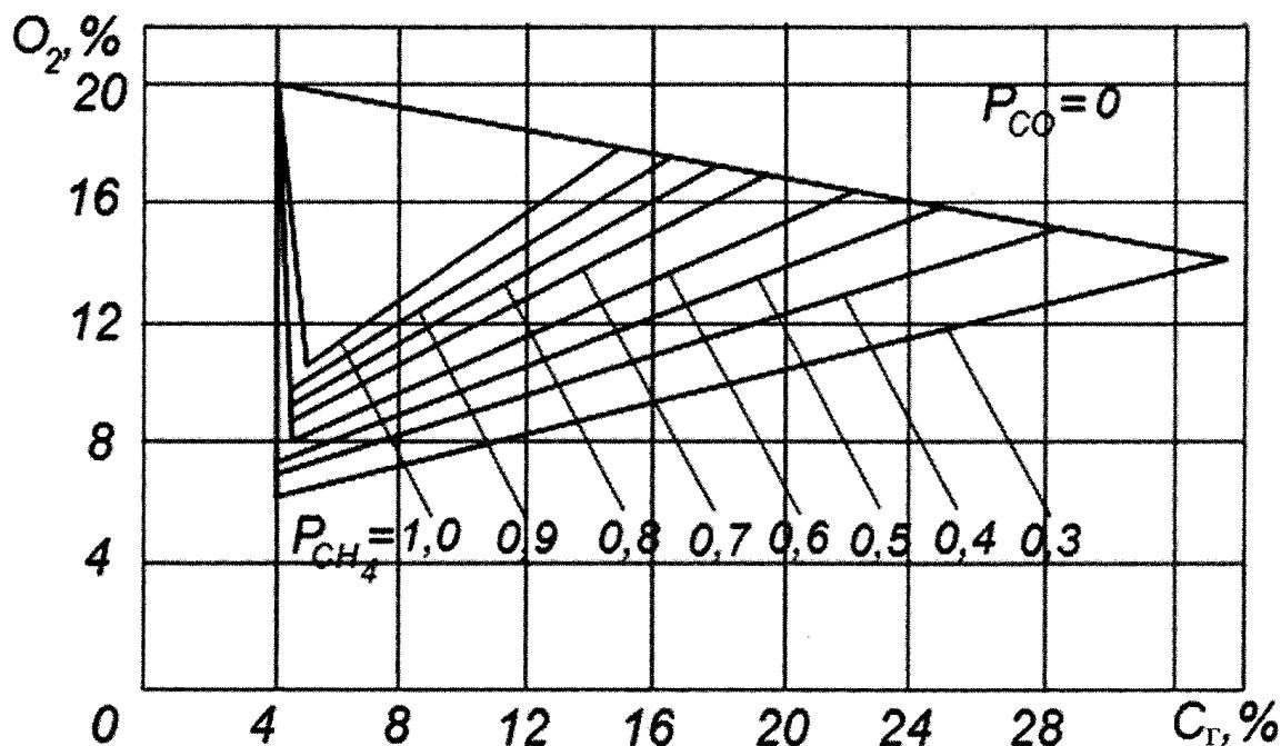
Рис. 1. Треугольник взрываемости при  $P_{CO} = 0,0$
