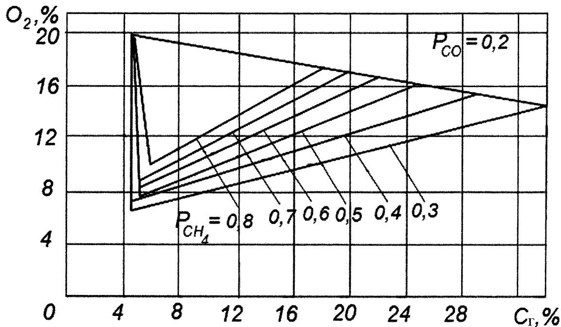
Рис. 3. Треугольник взрываемости при  $P_{CO} = 0,2$
