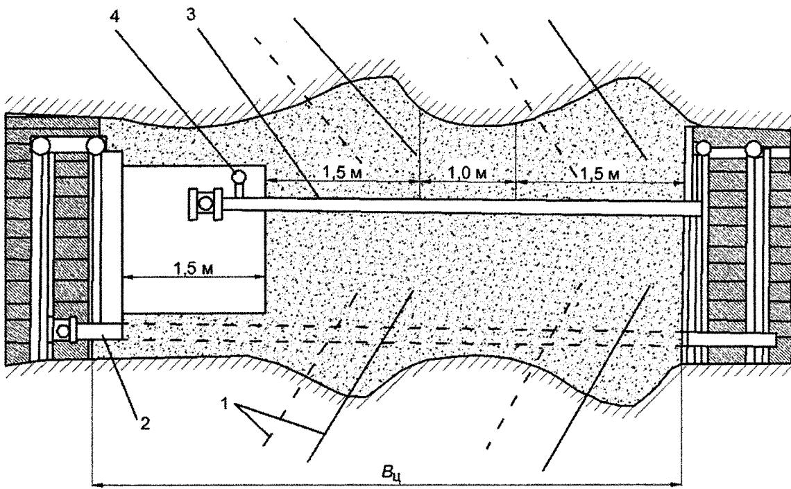
Рис. 9. Цилиндрическая водоупорная перемычка (вертикальный разрез): 1 - металлические анкеры для усиления перемычки, возводимой в неустойчивых породах; 2 - труба для спуска воды; 3 - труба для выхода избыточного воздуха при подъеме уровня воды; 4 - манометр
