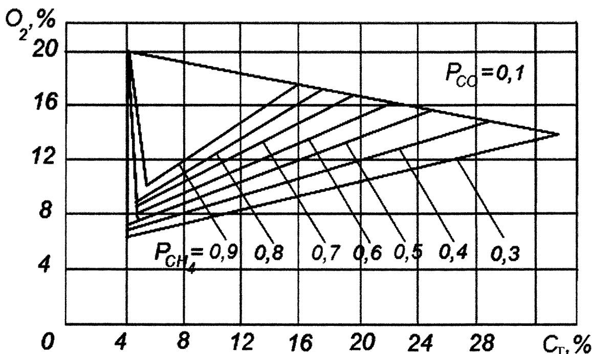
Рис. 2. Треугольник взрываемости при  $P_{CO} = 0,1$
