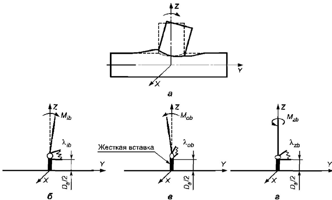
а - общий вид; б - изгиб в плоскости (вокруг оси X);
