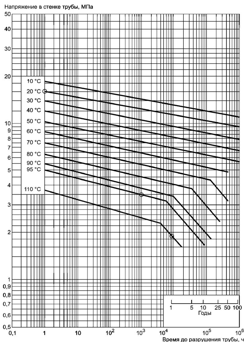
Рисунок Е.1. Эталонные кривые длительной прочности
