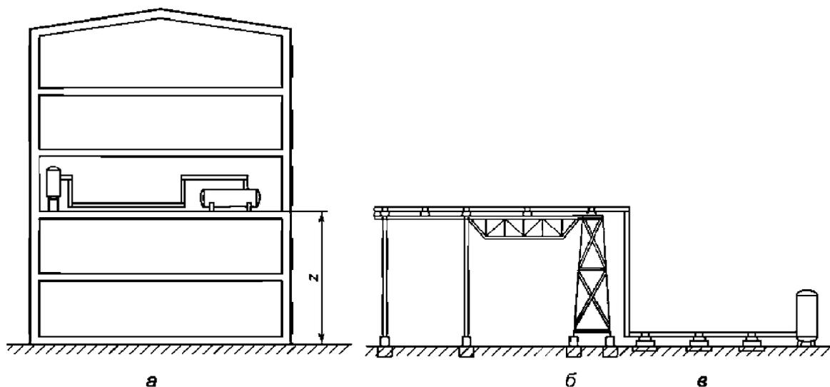
а - трубопровод в здании; б - трубопровод на эстакаде;
