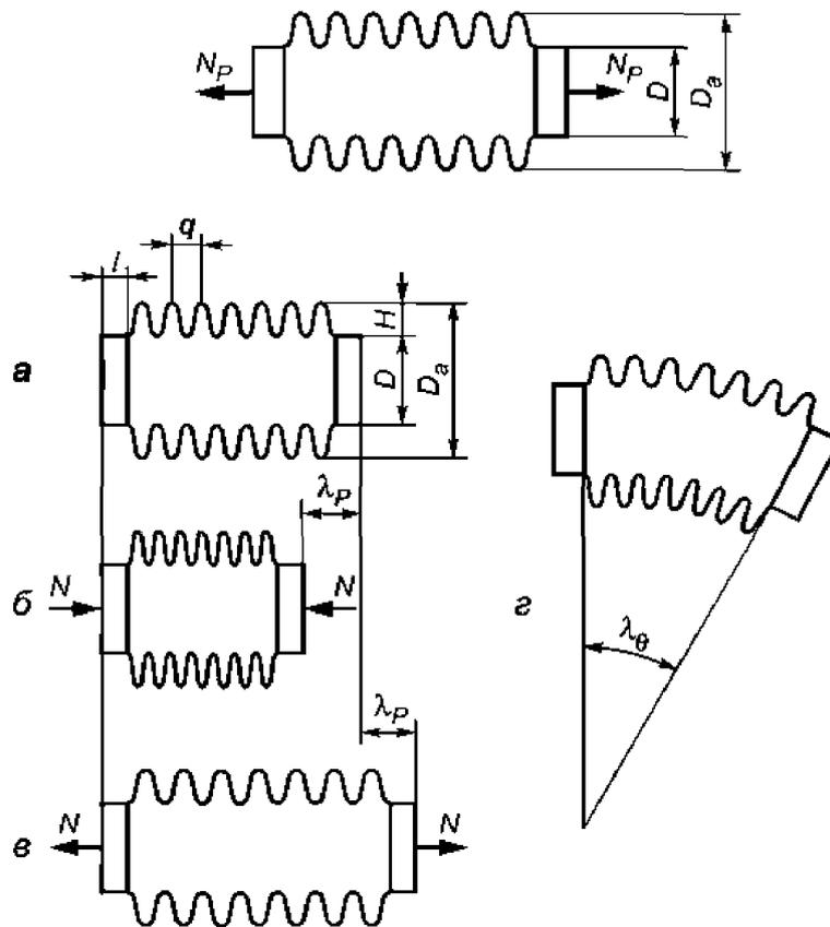
Рисунок 8.4. Схема работы осевого и углового компенсаторов
