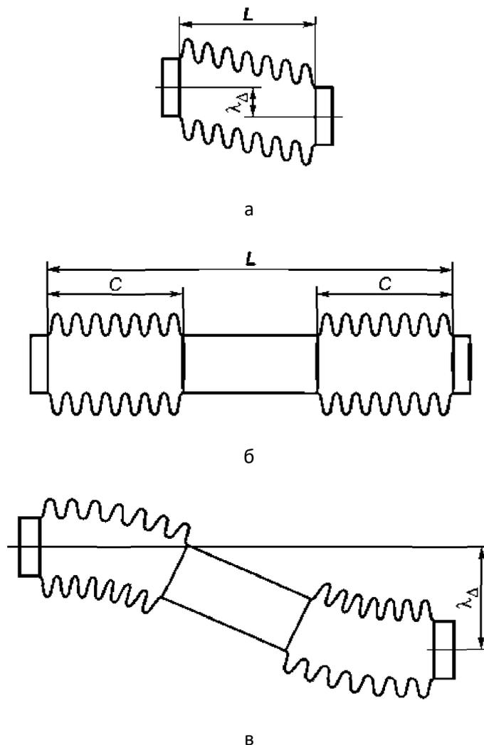
Рисунок 8.5. Схемы работы сдвиговых компенсаторов
