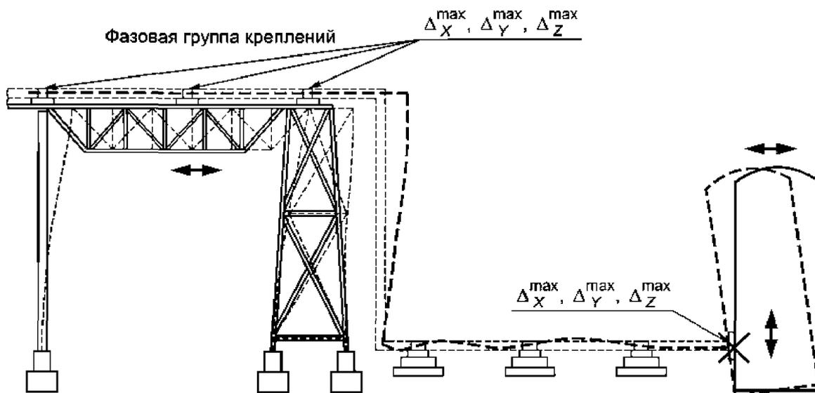
Рисунок 16.3. Сейсмические смещения креплений
