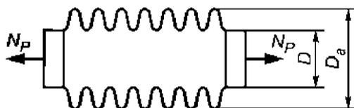
Рисунок 8.6. Схема приложения распорных усилий в осевом компенсаторе
