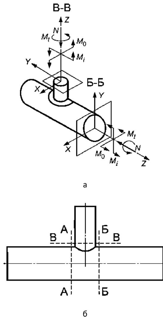
а - схема нагружения в расчетных сечениях;
