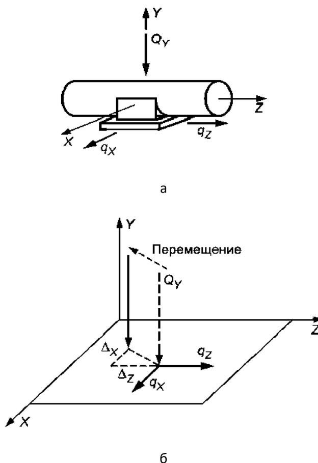
Рисунок 8.3. Схема нагрузок на опору
