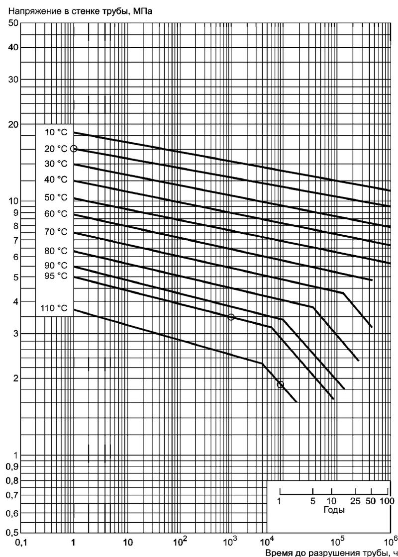
Рисунок Е.1. Эталонные кривые длительной прочности
