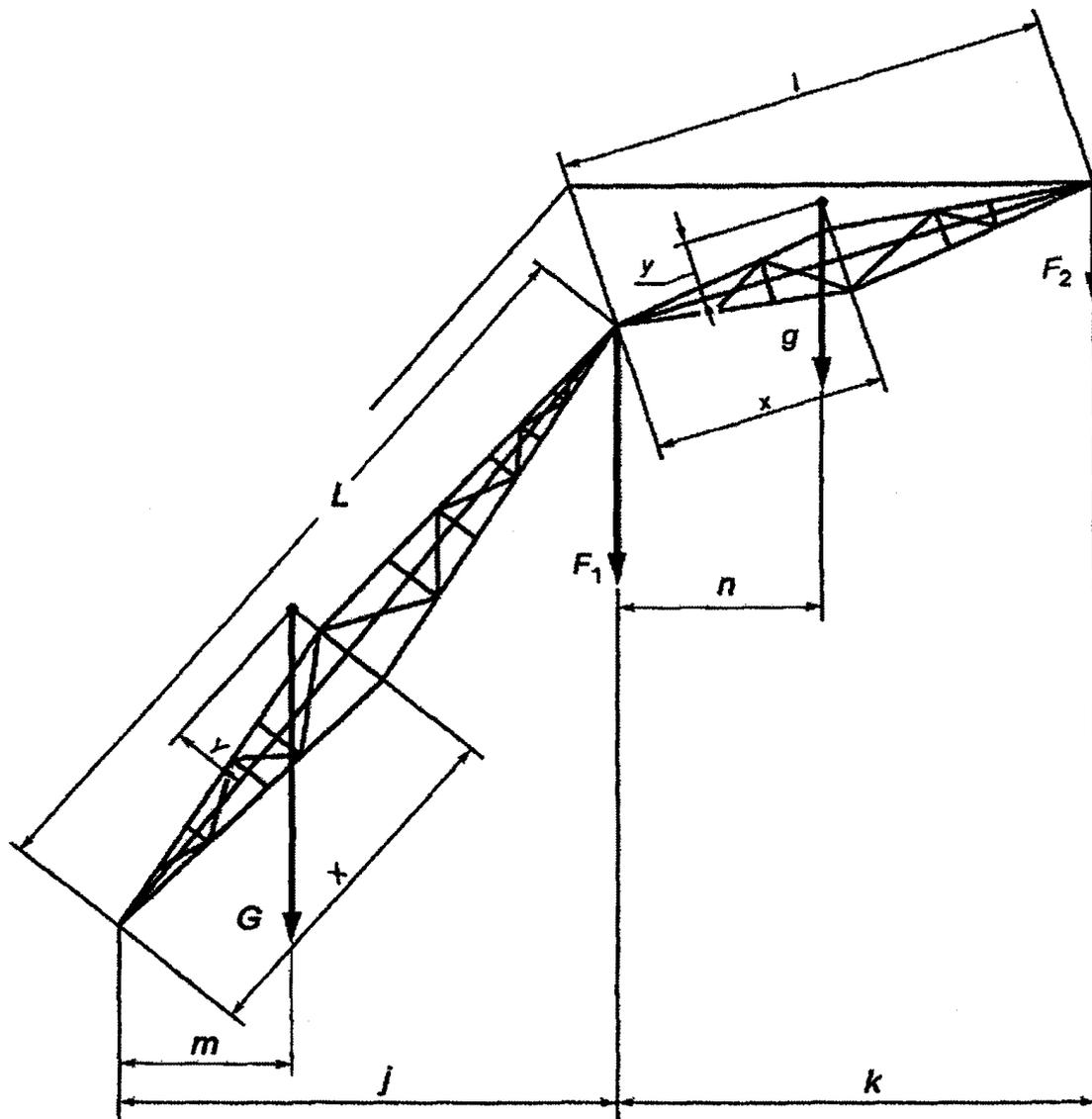
Схема Обозначение параметров для определения испытания кранов на устойчивость
