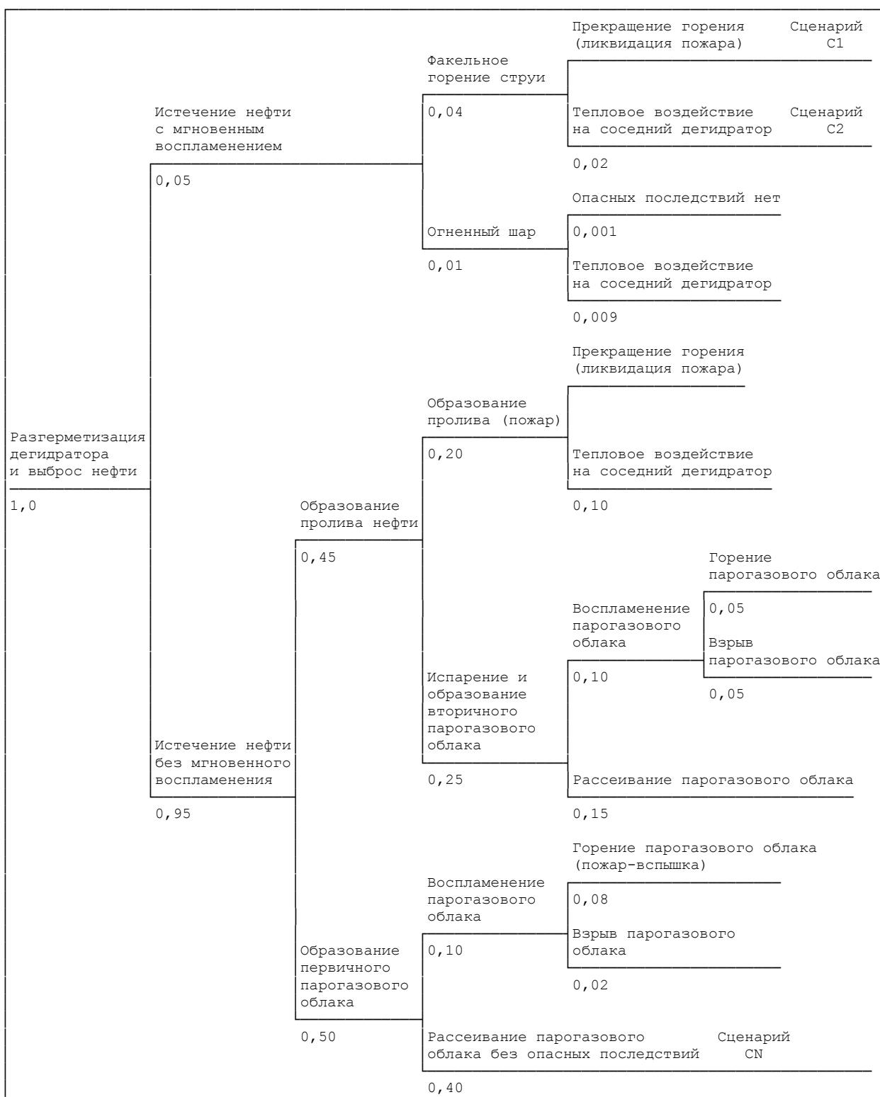
Вероятность разгерметизации дегидратора:  $P_0 = 1 \times 10^{-4}$  год<sup>-1</sup>.
