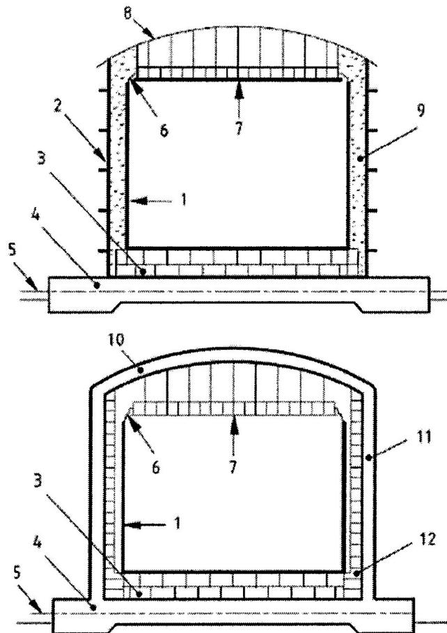
Рисунок 1. Двустенный (двухоболочечный с полной герметизацией) резервуар
