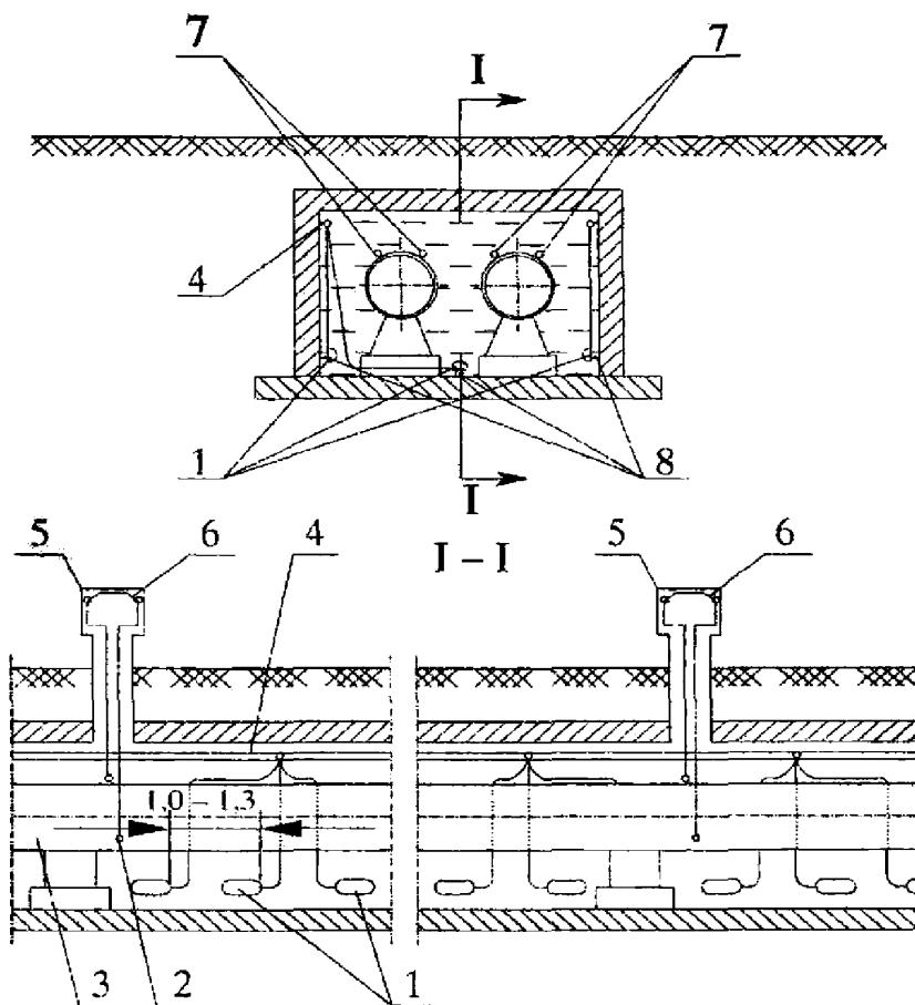
1 - магниевые протекторы; 2 - вспомогательный электрод; 3 - трубопровод; 4 - распределительный кабель; 5 - КИП; 6 - электроперемычка; 7 - магниевые протекторы стержневого типа; 8 - диэлектрические опоры
