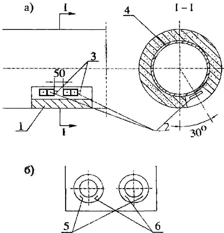
1 - теплоизолирующая конструкция; 2 - блоки пластин-индикаторов;
