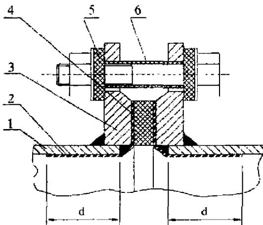
1 - трубы; 2 - диэлектрическое антикоррозионное покрытие;
