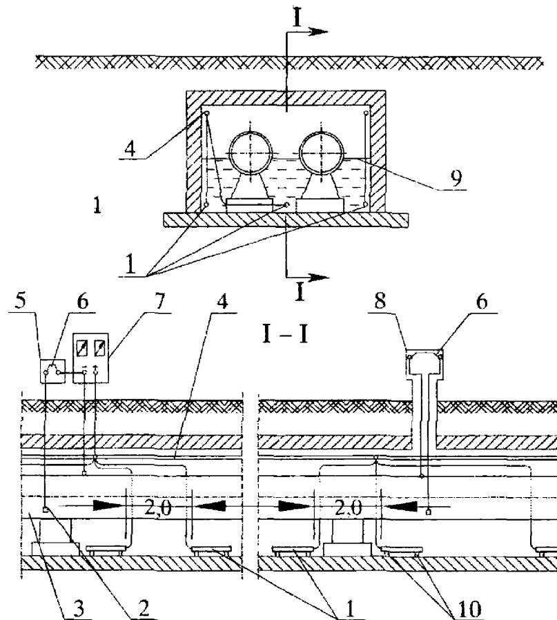
1 - электроды АЗ стержневого типа <\*>; 2 - вспомогательный электрод; 3 - трубопровод; 4 - распределительный кабель; 5 - КИП у станции катодной защиты; 6 - электроперемычка; 7 - станция катодной защиты (преобразователь); 8 - КИП; 9 - уровень затопления канала; 10 - диэлектрические опоры
