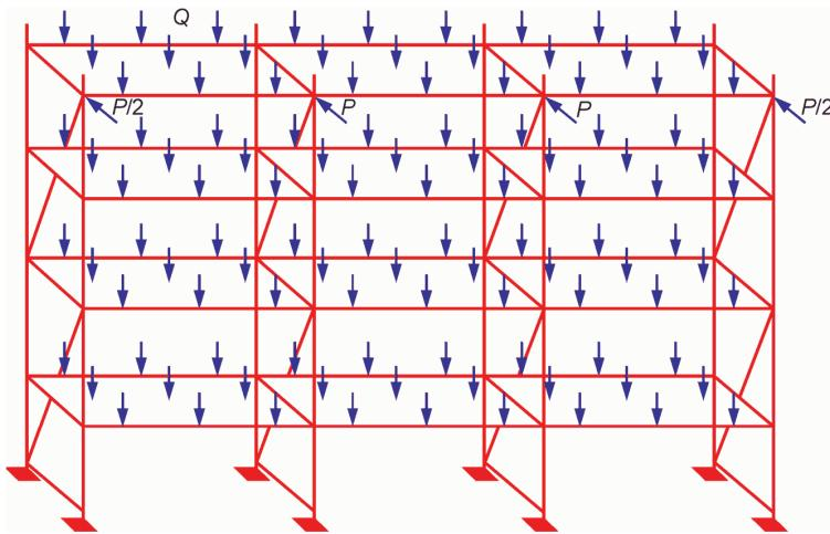
Рисунок 8 - Испытание на воздействие вертикальной нагрузки
