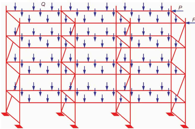
Рисунок 9 - Испытание на воздействие горизонтальной нагрузки
