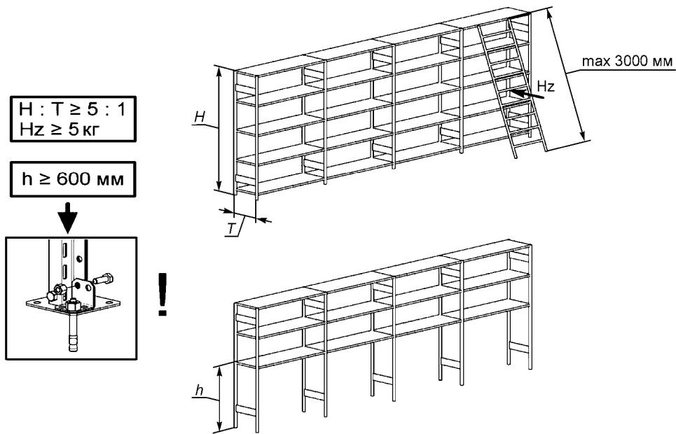
Рисунок 11 - Требования по креплению стеллажа к полу
