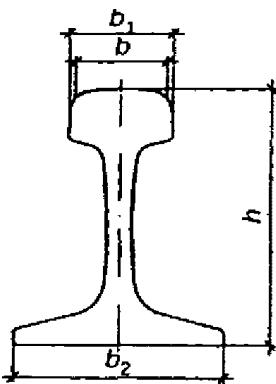
$b$  - ширина головки рельса вверху;  $b_1$  - ширина головки рельса внизу;  $b_2$  - ширина подошвы рельса;  $h$  - высота рельса
