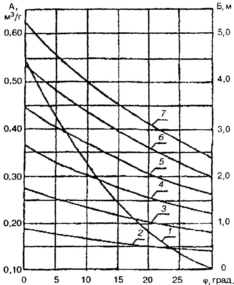
1 - кривая зависимости А от  $\varphi$ ; 2 - 7 - кривые зависимости параметра Б от  $\varphi$  при  $C_p$ , равном соответственно 4,9; 9,8; 14,7; 19,6; 24,5; 29,4 кН/м<sup>2</sup>
