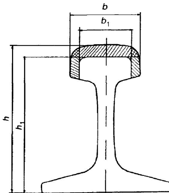
$b$  - ширина головки рельса, мм;  $b_1$  - предельные значения по ширине головки рельса, мм;  $h$  - высота рельса, мм;
