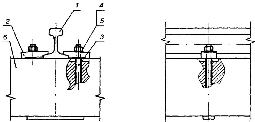
1 - рельс; 2 - прижим; 3 - шпилька; 4 - гайка; 5 - пружинная шайба; 6 - железобетонный опорный элемент (плита)
