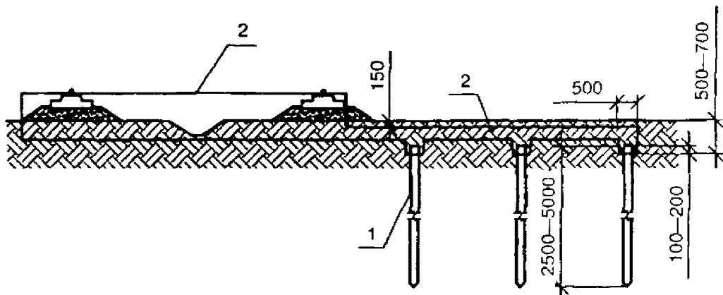
1 - заземлитель; 2 - заземляющий проводник
