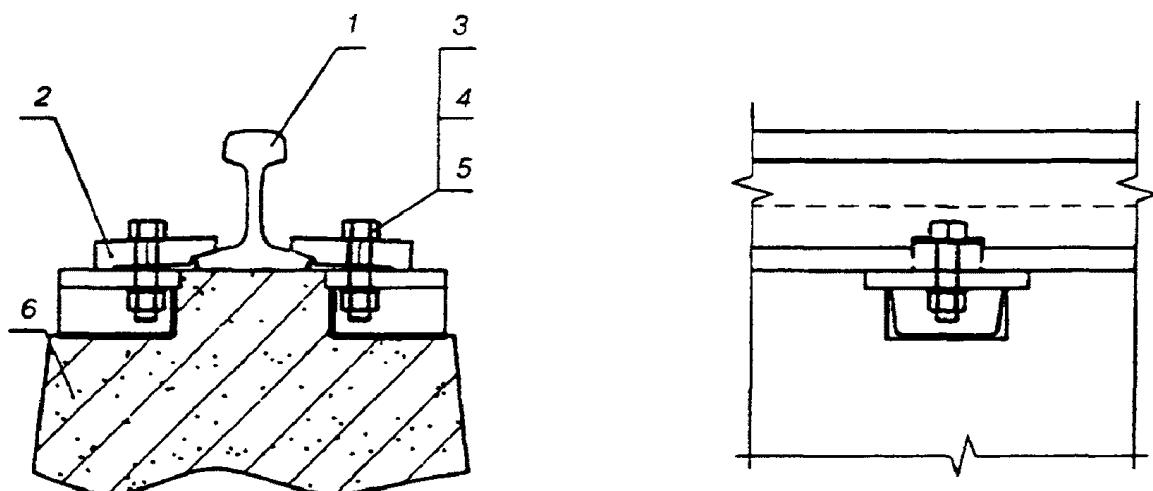
1 - рельс; 2 - прижим; 3 - закладной болт; 4 - гайка;
