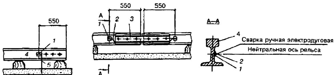
1 - промежуточная пластина; 2 - перемычка; 3 - накладка;
