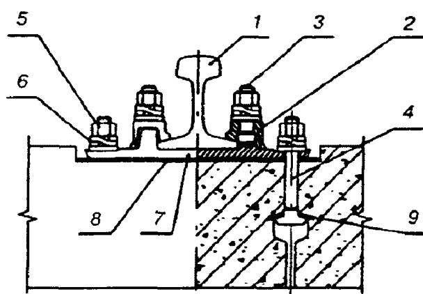
1 - рельс; 2 - жесткая клемма; 3 - клеммный болт;
