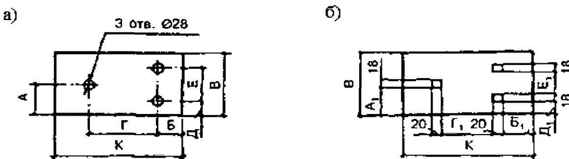
Рисунок 1 - Крепление рельса к полуспалам с помощью шурупов (а) и с помощью костылей (б)
