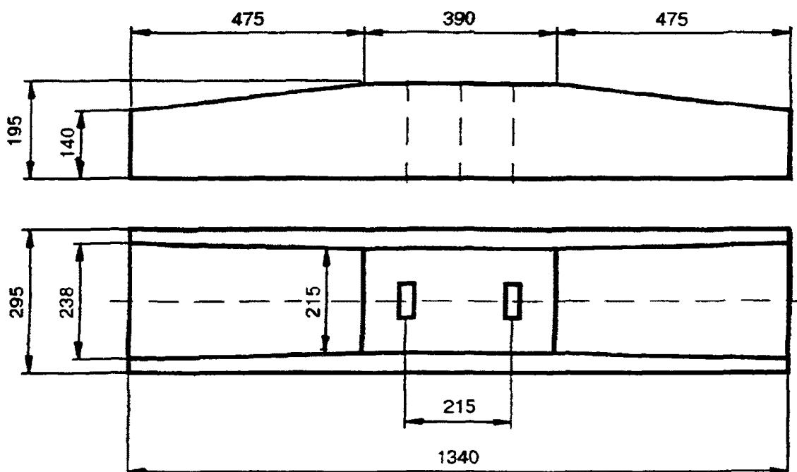
Рисунок Д.3 - Железобетонная полуушпала типа ПШН4-13-325-1Б3
