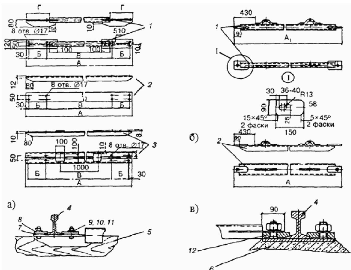
1 - стяжка из трубы; 2 - стяжка из швеллера; 3 - стяжка из уголков; 4 - рельс; 5 - полуушпала; 6 - железобетонная балка; 7 - прокладка; 8 - планка прижимная; 9 - болт; 10 - гайка; 11 - пружинная шайба; 12 - прижим
