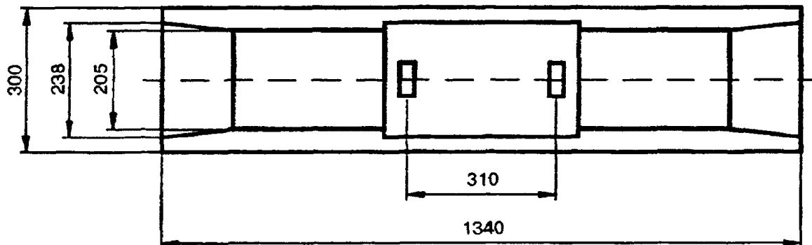
Рисунок Д.2 - Железобетонная полуушпала типа ПШН1-13-325-1
