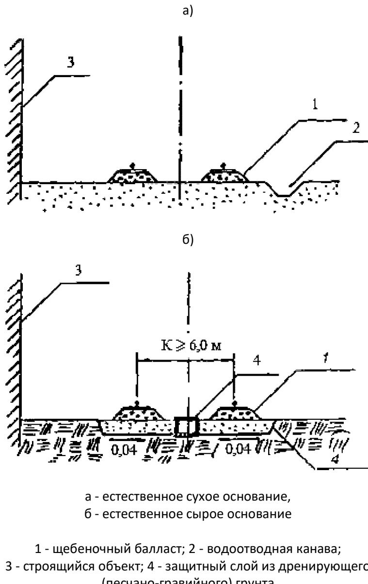
Рисунок 5 - Земляное полотно "нулевого места"
