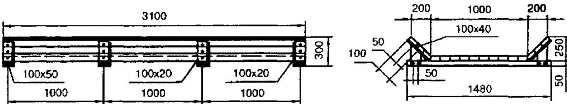
Рисунок 13 - Настыль для укладки кабеля для крана, не оборудованного кабельным барабаном
