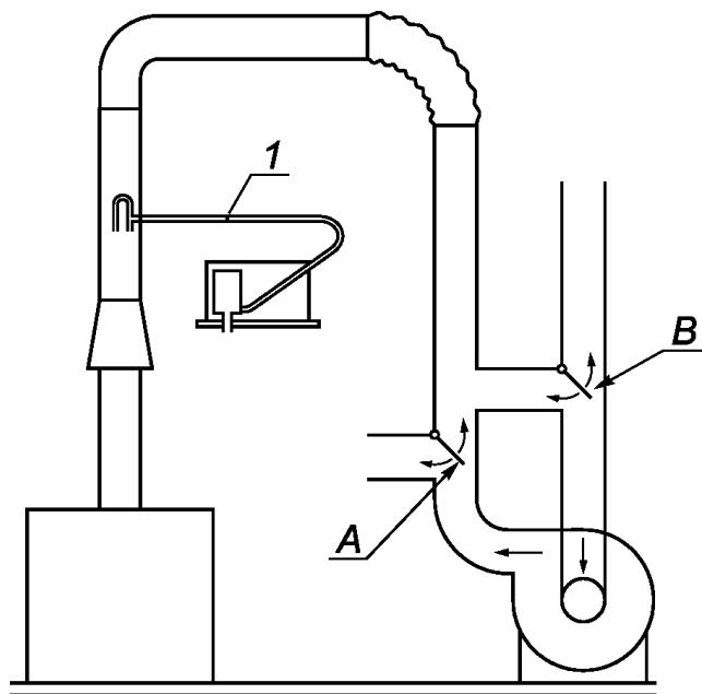
1 - измерение скорости с помощью трубы полного давления;
