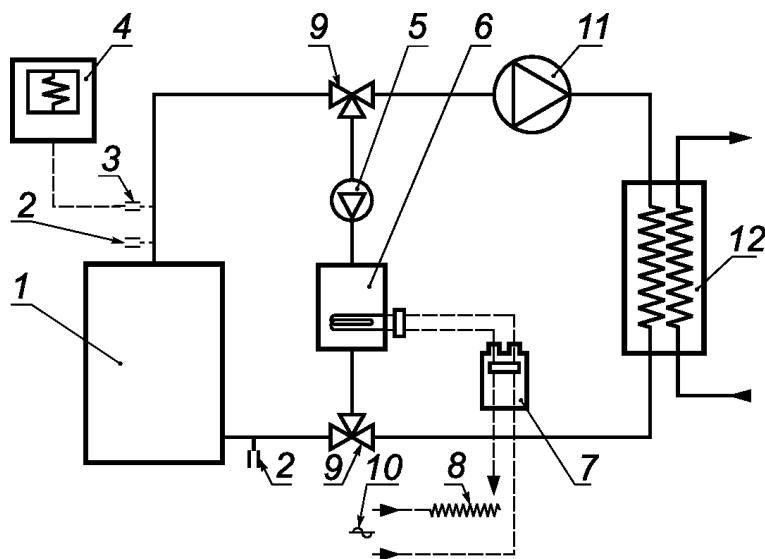
1 - испытываемый котел; 2 - термодатчики;
