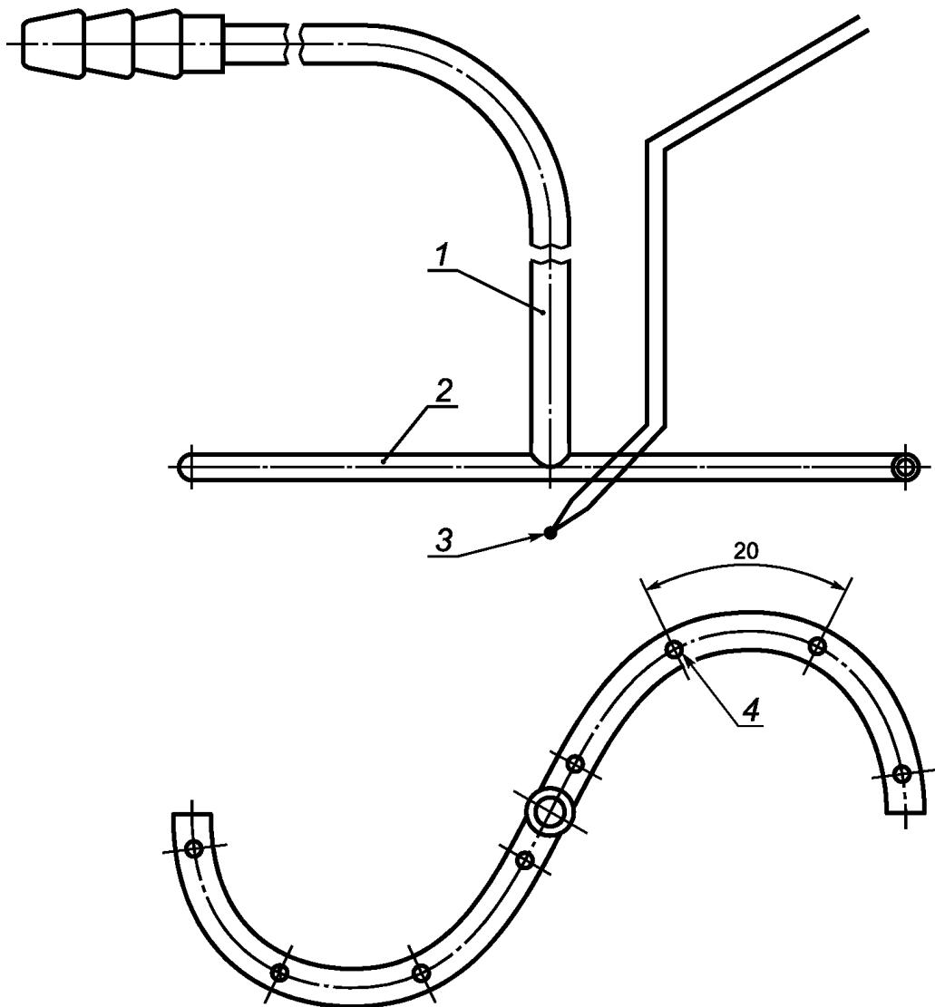
1 - медная трубка  $\varnothing 6$ ; 2 - медная трубка  $\varnothing 4$ ;
