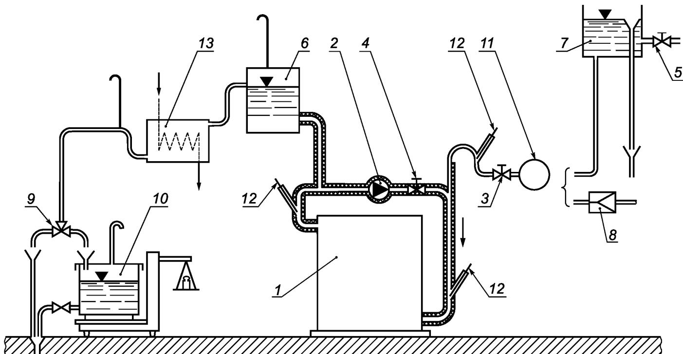
1 - испытуемый котел; 2 - циркуляционный насос;
