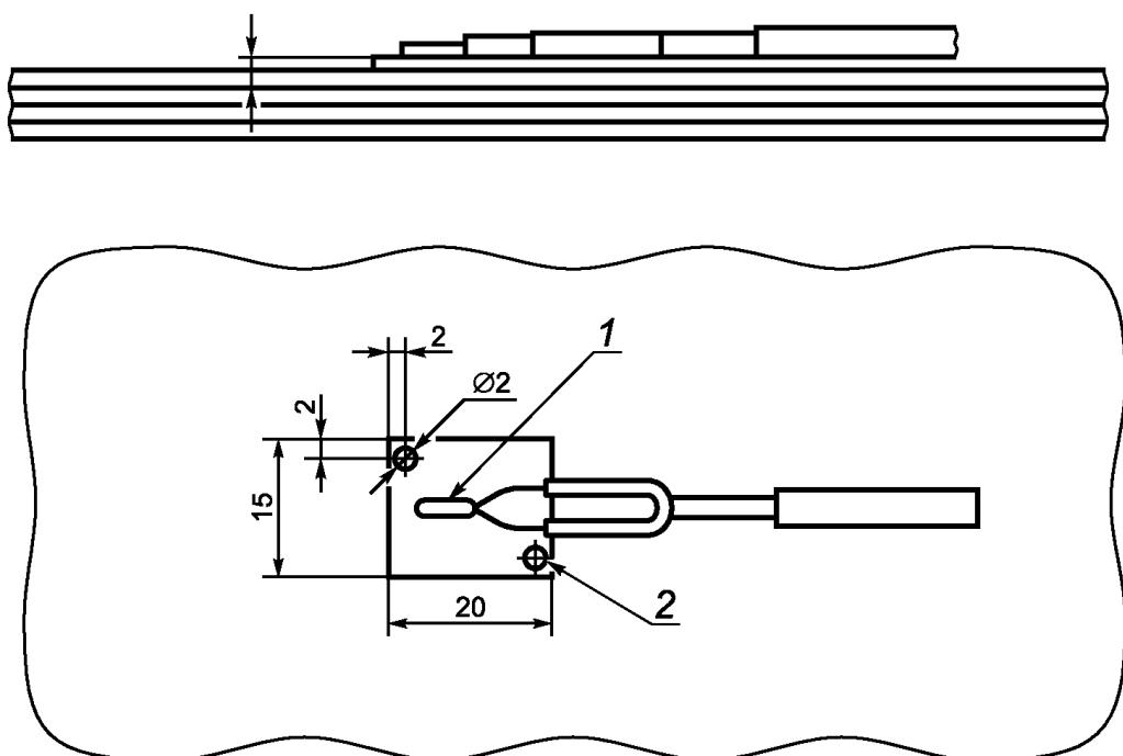
1 - термопара, напаянная на медную пластину;
