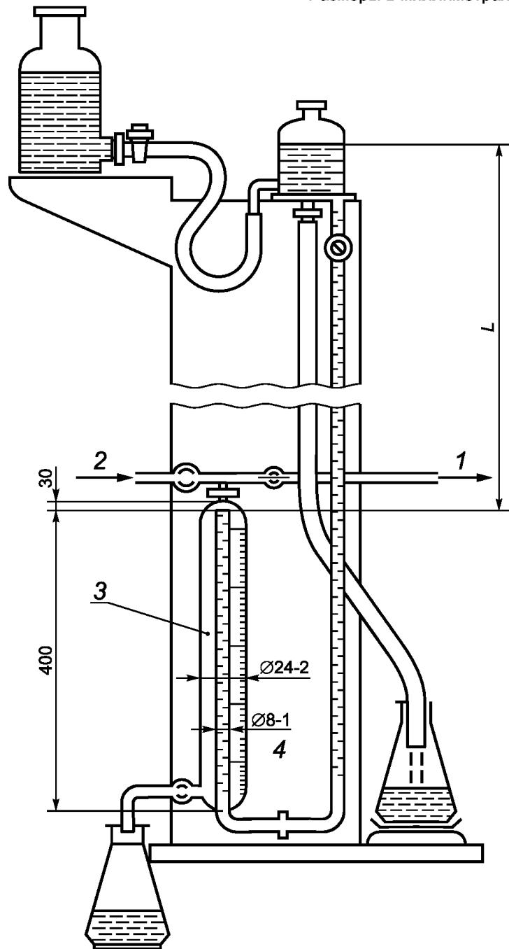
1 - испытуемый прибор; 2 - сжатый воздух; 3 - измерительный сосуд; 4 - градуированная шкала;  $L$  - высота столба жидкости, эквивалентная испытательному давлению (см. 7.2.1)
