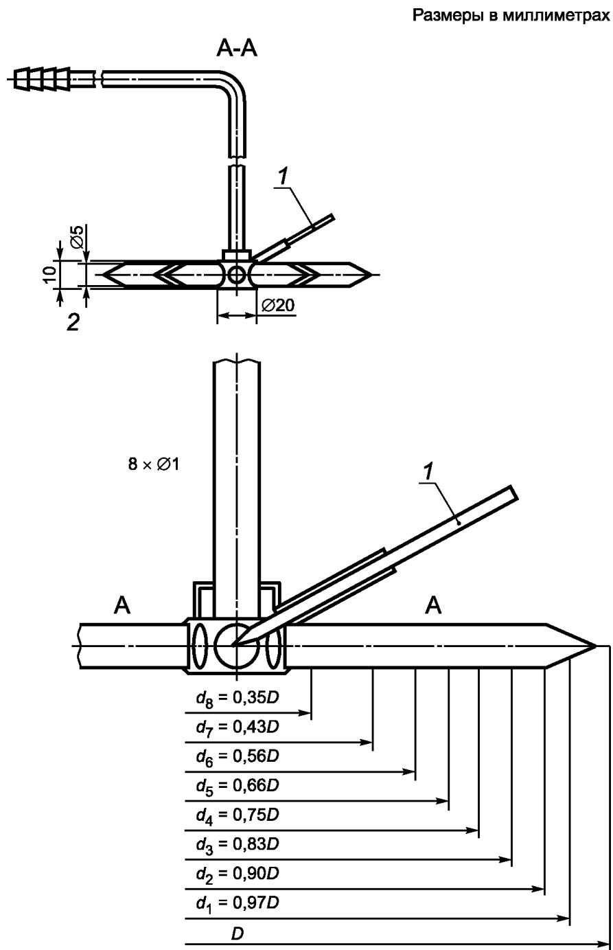
1 - термопара; 2 - пробоотборник; D - диаметр дымохода
