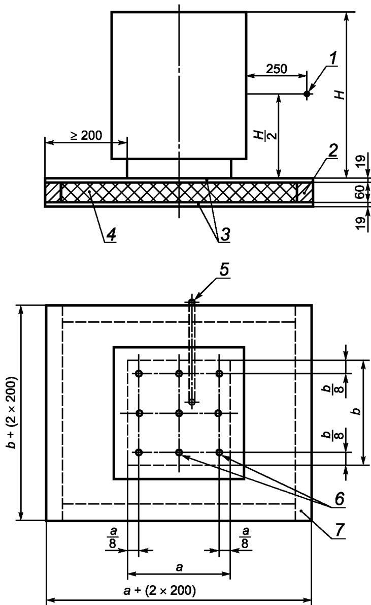
1 - точка измерения температуры воздуха; 2 - рама из четырехгранных брусьев; 3 - деревянный настил с канавкой и изгибом; 4 - стекловолокно; 5 - полая трубка для измерительного кабеля; 6 - точки измерения; 7 - испытательная поверхность для измерения температуры основания
