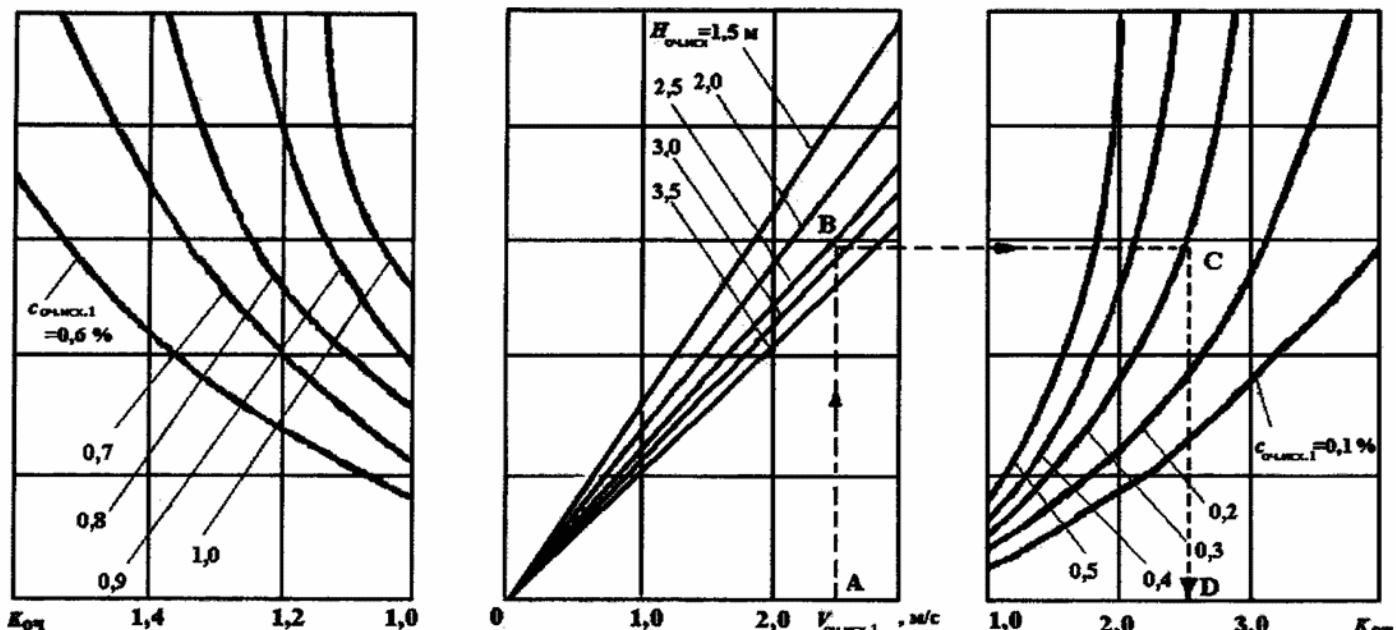
Рис. 7. Номограмма для определения  $K_{\text{оч}}$ .
