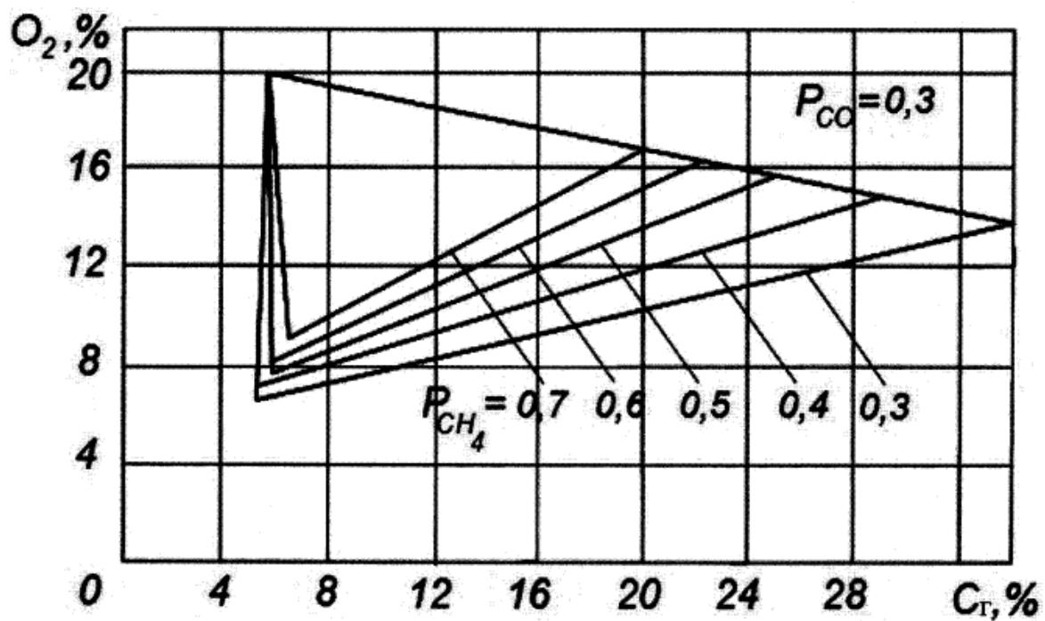
Рис. 4. Треугольник взрываемости при  $P_{CO} = 0,3$ .
