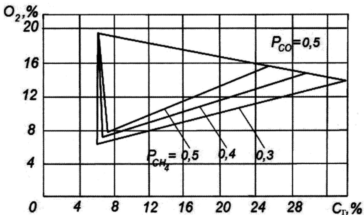
Рис. 6. Треугольник взрываемости при  $P_{CO} = 0,5$ .
