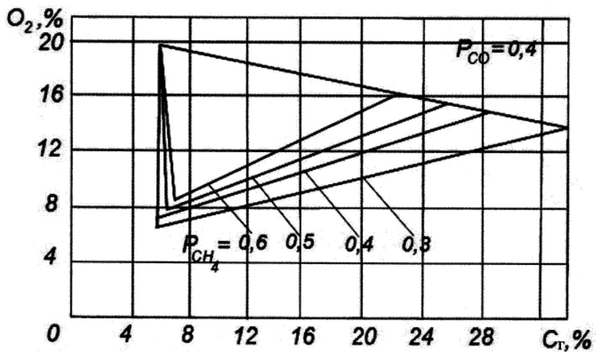
Рис. 5. Треугольник взрываемости при  $P_{CO} = 0,4$ .
