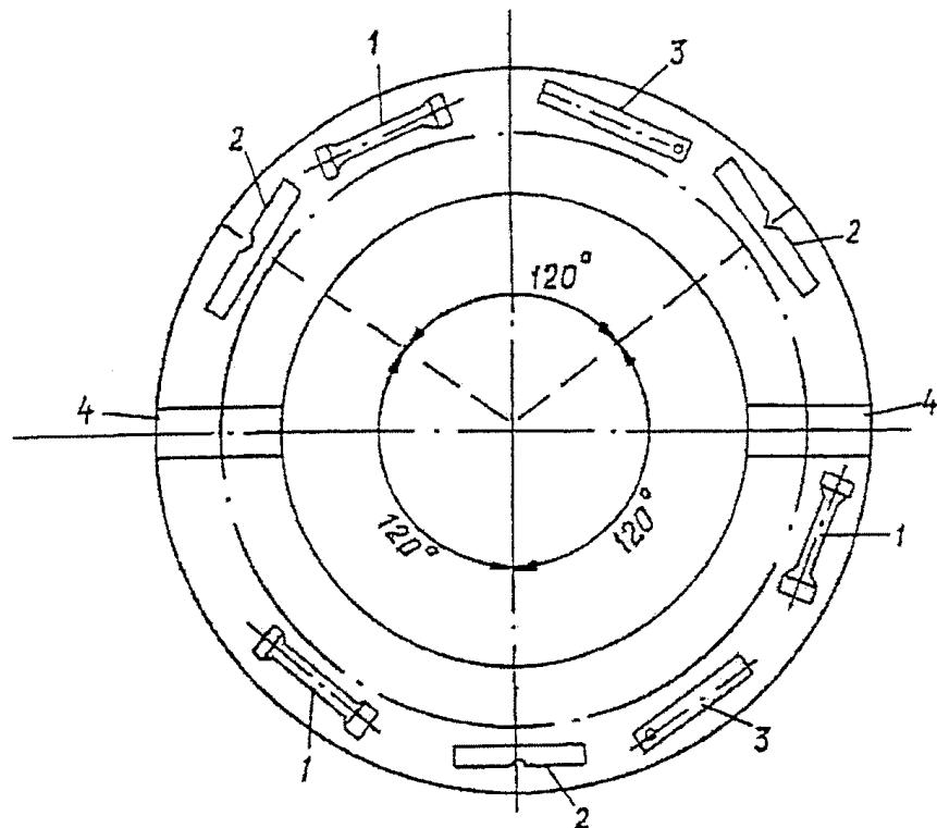
1 и 2 - образцы для испытания соответственно на разрыв и удар;
