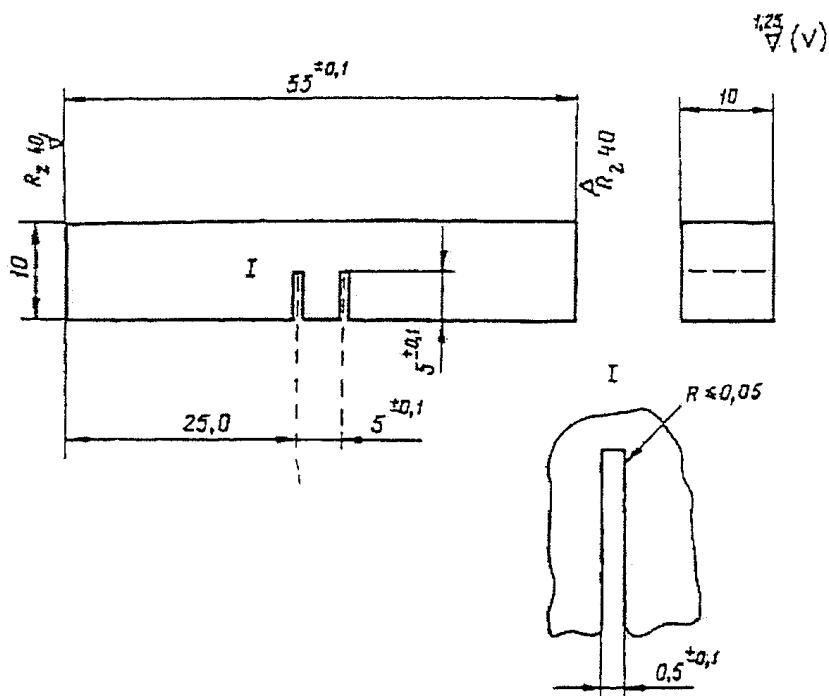
Рис. 4. Ударный образец с двумя надрезами
