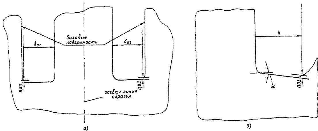
Рис. 5. Схема измерения критического раскрытия
